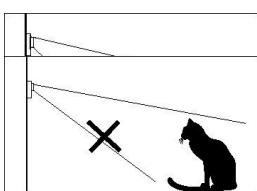
Vermeiden Sie die Montage an Orten welche in unmittelbarer Nähe Geräte stehen haben die eine schnelle Temperaturänderung herbeiführen können. z.B. Zentralheizkörper, Heizkörper, Luftschächte, Klimaanlagen, Feuer,...
