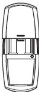
Um das Batteriefach zu öffnen ziehen Sie die Abdeckung einfach nach oben weg nachdem Sie die kleine Schraube gelöst haben.
