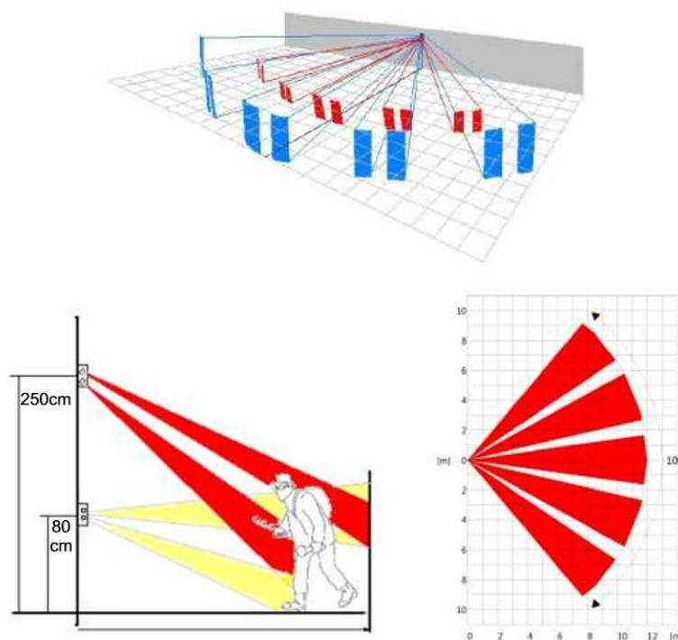
Setzen Sie den Detektor zur Überwachung von einer Tiefe von maximal 12 m ein. Die Winkelöffnung beträgt  $100^\circ$  (ohne Abdeckung). Um eine zuverlässige Erkennung zu erhalten, ist es empfehlenswert, den Detektor so zu montieren das dieser etwaigen Personen von der Seite erkennt, bzw. diese den Sensor seitlich passieren.
