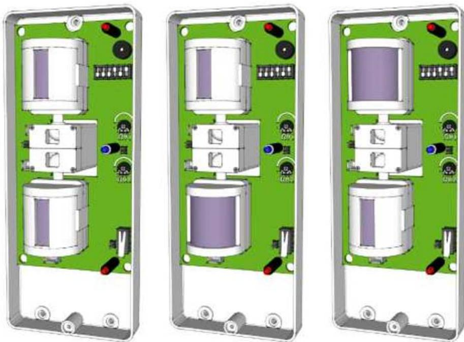
**E** Die Erfassungsköpfe sollten optimal parallel, oder nach unten, zum Boden eingestellt werden, aber nie nach oben. Dies ist zu vermeiden. Ebenfalls sollte eine Ausrichtung direkt auf Sonneneinstrahlung vermieden werden. Um eine Immunität gegen kleinere Tiere o.ä. zu erreichen sollten die Erfassungsköpfe divergierend (von einander abweichend, parallel zueinander) eingestellt werden. So ist gewährleistet das bei der UND Erkennung nur bei Erkennung in beiden Köpfen ein Alarm ausgelöst wird.
